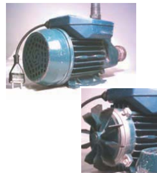
Fig.13- Ailettes de refroidissement sur le stator d'un moteur ; (A droite on a ôté la grille du ventilateur).
