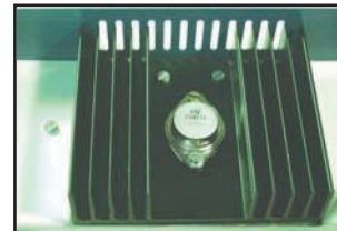
Fig.12- Radiateur (remarquer sa couleur noire) du transistor de puissance d'une alimentation stabilisée
